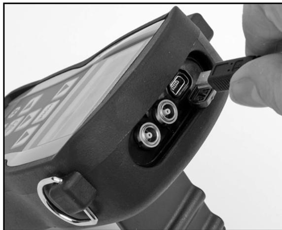
图 21: Mini USB COM 端口的位置
