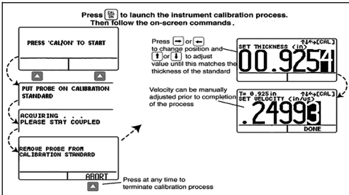
图 12: 仪器校准程序（自动模式）
